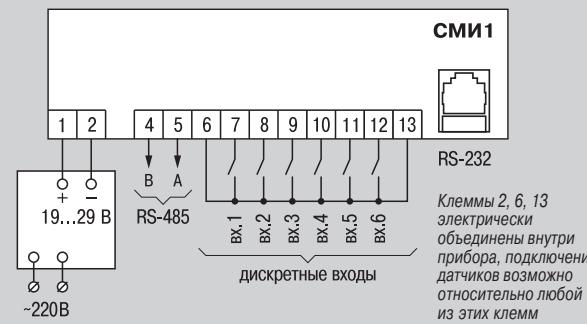
▲ Схема подключения СМИ1-24
