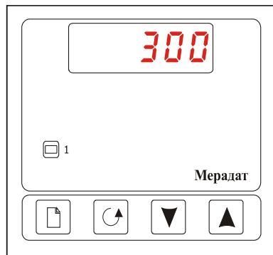
При нажатии кнопки  $\nabla$  на индикаторе появится надпись  $\text{r.} \text{En} \text{ I}$  - обнуление значения счетчика. Для обнуления счетчика необходимо кнопками  $\nabla$ ,  $\Delta$  выбрать значение  $\text{YES}$  и нажать кнопку  $\text{O}$ .
